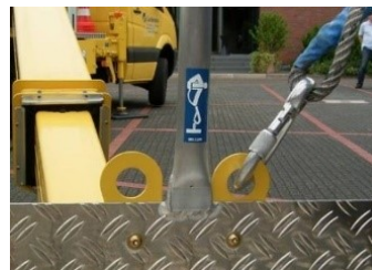
Bild 1: Verwendung der vom Hersteller bezeichneten Anschlagpunkte (> 3kN), Anschlagpunktpositionen: bodennah, max. Höhe Mittelholm, nicht am Geländer!
