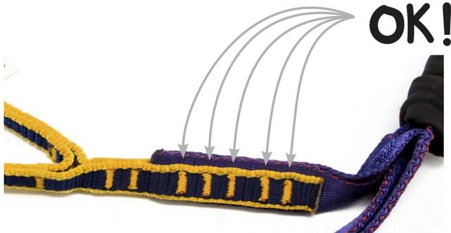
**Wenn eine oder mehrere Zickzacknähte fehlen, lose, beschädigt oder unvollständig sind, muss das Produkt aus dem Verkehr gezogen und an den PETZL Distributor in Ihrem Land gesendet werden.**
