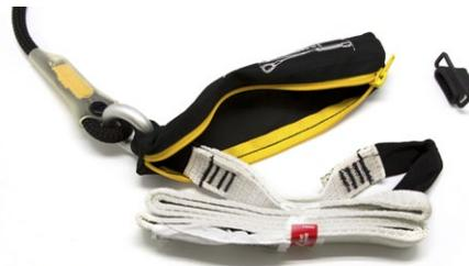
3 - Überprüfen Sie auf der Seite des Verbindungsmittels auf der Ober- und Unterseite das Vorhandensein der Sicherheitsnaht, die aus vier schwarzen Zickzacknähten besteht. Sie verbindet die weißen Aufreiß-Bandschlingen mit dem schwarzen Verbindungsmittel\*.
