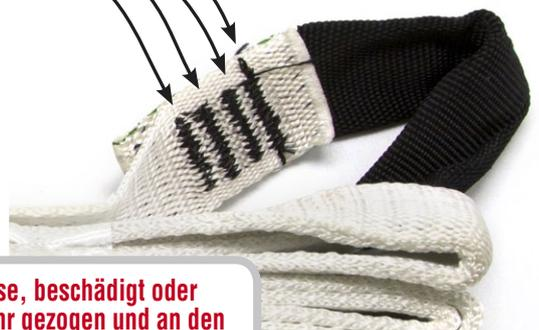
**Wenn eine oder mehrere Zickzacknähte fehlen, lose, beschädigt oder unvollständig sind, muss das Produkt aus dem Verkehr gezogen und an den PETZL Distributor in Ihrem Land gesendet werden.**
