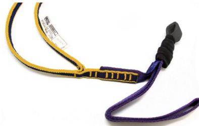
3 - Überprüfen Sie auf der Seite des Verbindungsmittels auf der Ober- und Unterseite das Vorhandensein der Sicherheitsnaht, die aus fünf gelben Zickzacknähten besteht. Sie verbindet die blauen Aufreiß-Bandschlingen mit dem blau/gelben Verbindungsmittel\*.
