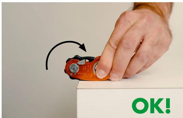
Wenn der Nocken in seine Position zurückkehrt, bedeutet dies, dass das Produkt keinen Defekt aufweist und frei verwendet werden kann.
